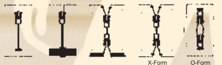
nicht teilbar closed-end non détachable teilbar open-end détachable 2-Wege teilbar Two-way separator Double curseurs détachable X-Form Zipper with double sliders closed-end O-Form Zipper with double sliders closed-end Double curseurs non détachable
